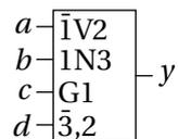
(b) Definieren Sie ein Schaltsymbol zur Aussageform  $y := (a \vee bd) \oplus (c\bar{d} \vee bd)$ .
